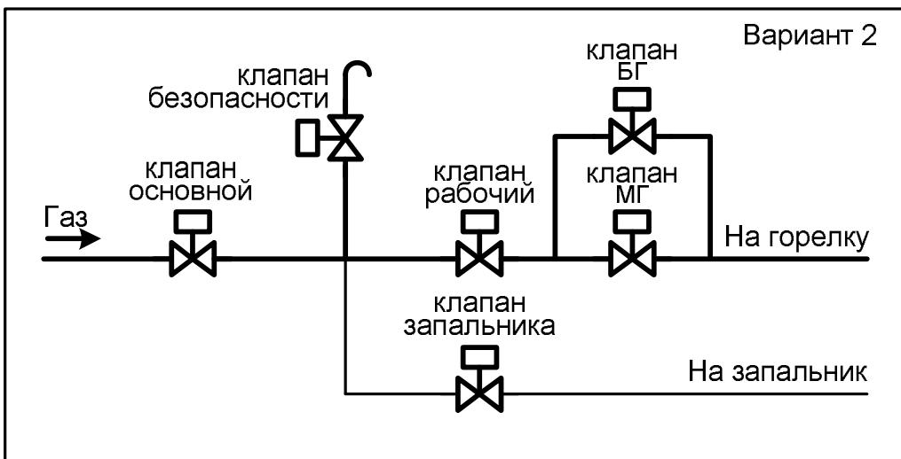
Регулирование мощности производится по соотношению давлений «газ-воздух», «газ-разрежение», клапанами большого (БГ) и малого (МГ) горения, по сопротивлению реостатного датчика МЭО.
