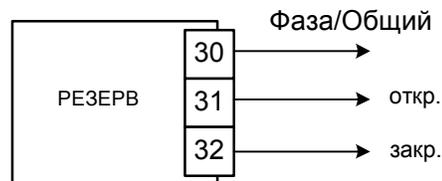
При заказе необходимо указывать тип выходов на исполнительные механизмы (МЭО, ПБР, Частотный преобразователь). По умолчанию все выходы - симисторные, для управления МЭО.
