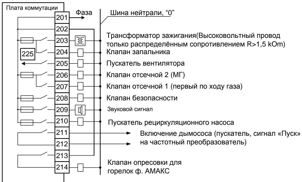
Параллельно всем контактам реле установлена RC-цепь(50 Ом;0,022 мкФ),Что может повлиять при работе на нагрузку с малым током потребления. Для исключения этого влияния можно подключить дополнительную нагрузку,например резистор .
