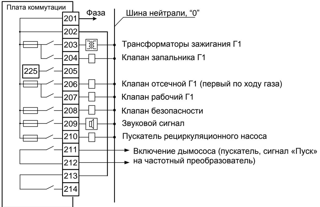
Параллельно всем контактам реле установлена RC-цепь (50 Ом; 0,022 мкФ), что может повлиять при работе на нагрузку с малым током потребления. Для исключения этого влияния можно подключить дополнительную нагрузку, например резистор.
