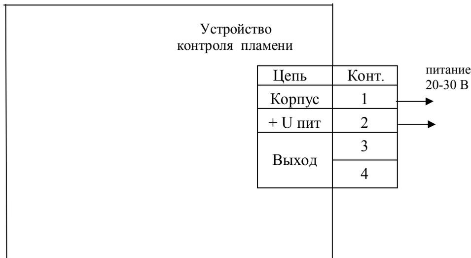
цветом индикатора. Оптимальную установку устройства контролируют по индикатору, добиваясь максимального зеленого цвета свечения. Чувствительность регулируется резистором, расположенным под индикатором. Ступенчато чувствительность регулируется переключателем «1», рядом с переменным резистором. В положении «ON» (верхнее положение движка переключателя) – чувствительность выше.
